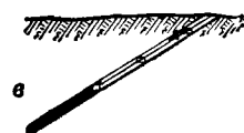
Схемы вскрытия месторождений полезного ископаемого при подземной разработке: а — вертикальным стволом; б — штольной; в — наклонным стволом
