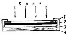
Схема контактной печати: 1 — накладная рама; 2 — негатив; 3 — позитивный фотоматериал; 4 — рама
