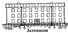
Схема заземления металлической крыши здания
