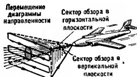
Схема работы самолётной радиолокационной станции перехвата и прицеливания
