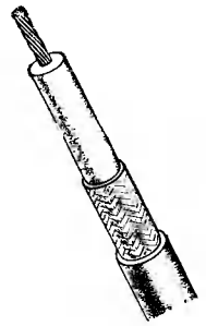
Коваксиальный кабель с многопроволочным внутренним проводником, сплошной изоляцией, внешним проводником в виде оплётки из медной проволоки и оболочки из пластмассы или резины
