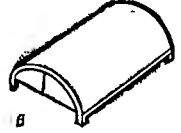
Типы поверхностей оболочек: а — положительной кривизны; б — отрицательной кривизны; в — нулевой кривизны
