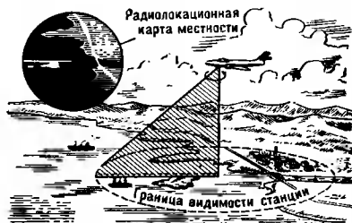
Самолётная радиолокационная станция кругового обзора. Схема обзора
