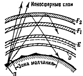
К ст. Мёртвая зона радиоприёма . Схема отражения пространственных волн дециметрового диапазона: D, E, F 1 и F 2 — ионосферные слои; П — радиопередатчик
