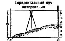
Схема геометрического нависирования : разность высот уровневых поверхностей, проходящих через точки А и В земной поверхности, h = a - b
