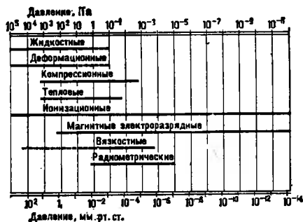
Диапазоны рабочих давлений различных вакуумметров (пунктиром показаны предельные давления)
