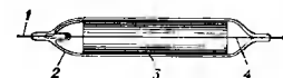
К ст. Гейгера—Мюллера счётчик. Схема стеклянно-го счётчика: 1 — вывод катода; 2 — герметически запаянная стеклянная трубка; 3 — катод (тонкий слой меди на трубе из нержавеющей стали); 4 — анод (тонкая металлическая нить)
